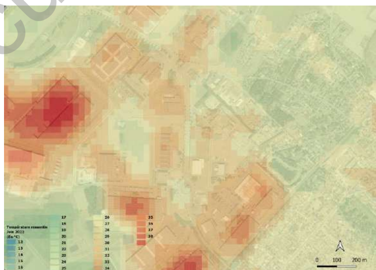
Figure 9: exemple d'une zone d'activités, on observe le halo de chaleur qui peut se déployer sur les plus grands bâtiments et ses alentours.
