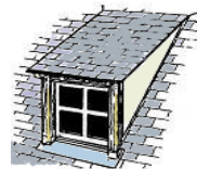
lucarne rampante ou en chien couché
