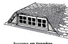
lucarne en trapèze ou rampante à jouées biaisées (couverture en bardeaux d'asphalte)
